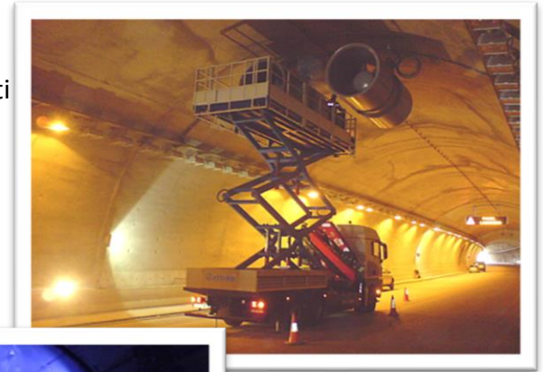
Figura 3 Autocarro speciale con piattaforma di lavoro
